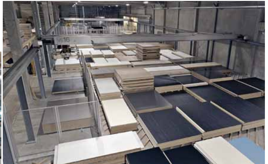
Flächenlager mit zwei Brücken und dem Einlagerplatz (Fotos: Rotpunkt Küchen)
