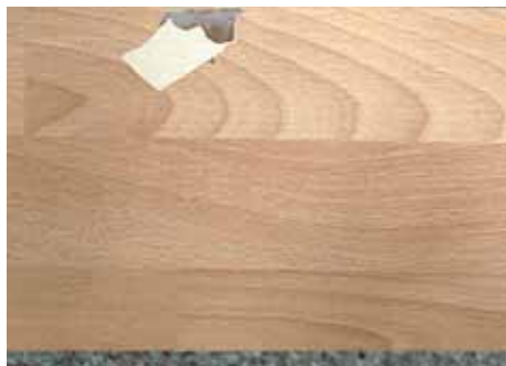
Papierersatz und Dekorrisse durch schlechte Papierlegung
