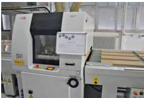
Am Anfang der 3D-Tiefziehpresse: Über die hintere Rollenbahn kommen die MDF-Frontteile direkt vom Zuschnitt und werden zusammengeführt
