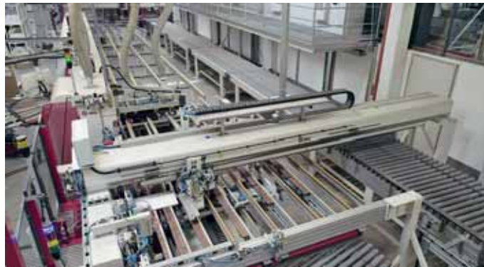
Das Servo-Einschub- und Anschlagssystem „A1/30“ richtet die Bauteile aus
