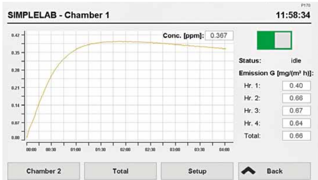
Abbildung 3: Zeitlicher Emissionsverlauf einer 19-mm-Spanplattenprobe
