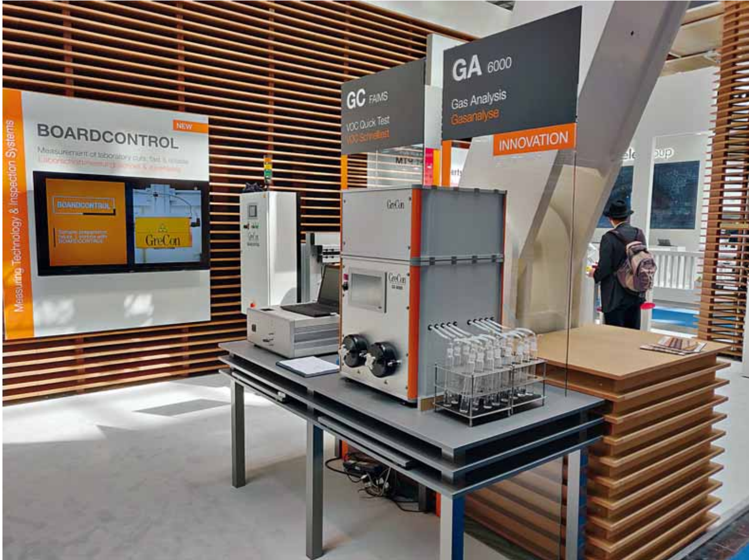
Abbildung 1: Formaldehyd-Prüfanlage „Gasanalyse“ mit aufgesetztem „Simplelab“-Analysator auf dem Ligna-Messestand von Fagus-GreCon 2019 (Foto: Manuel Fleisch)
