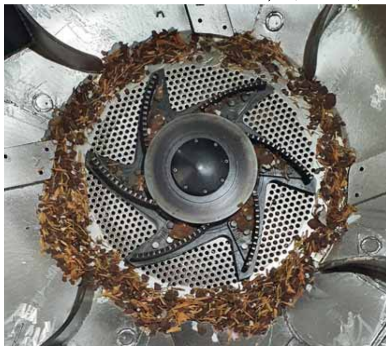
Abbildung 2: Pulperrotor mit Grob-Rejects (Foto: Valmet)
