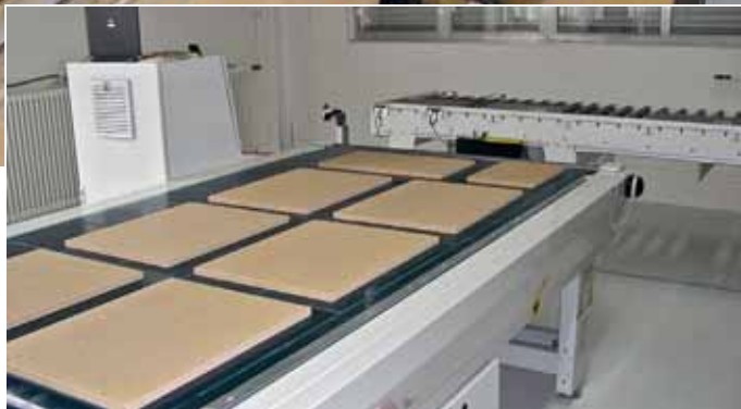
Am Anfang der 3D-Tiefziehpresse: Über die hintere Rollenbahn kommen die MDF-Frontteile direkt vom Zuschnitt und werden zusammengeführt
